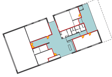
Rez-de-chaussée Schéma sécurité incendie
